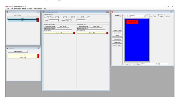
Die Oberfläche der Touchsteuerungen wird mittels der Software EL-EDIT-336 gestaltet. Im "Oberfläche" Fenster erfolgt die grafische Gestaltung. Jedem Steuerelement können bis zu 30 Befehle hinterlegt werden wenn das Steuerelement aktiviert wird, und es können bis zu 30 Befehle hinterlegt werden wenn das Steuerelement deaktiviert wird.
